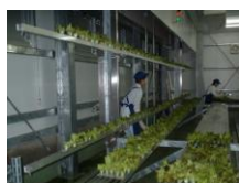
洗浄しやすいトイ状の水槽に定植後、水槽ごと昇降チェーンで栽培棚へ自動搬送
